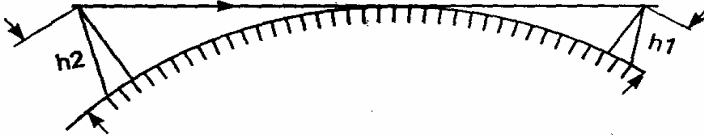
Рис. 3.10. Траєкторія поширення поверхневих радіохвиль
