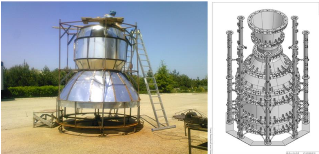
Рис. 1. Зовнішній вигляд дослідного зразка та конструкція енергетичної установки ІПЕ «СМЕРЧ».
