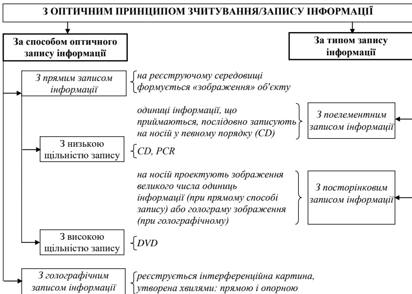
Рис. 1.2. Класифікація носіїв з оптичним принципом зчитування/запису
