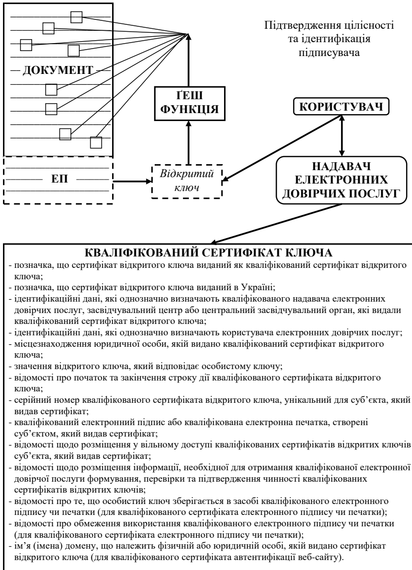
Рис. 7.3. Приблизна модель перевірки електронного підпису
