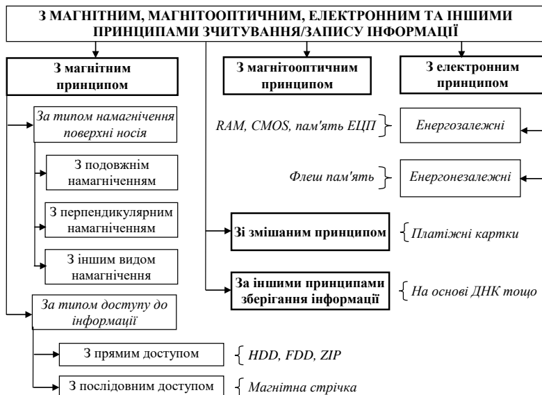
Рис. 1.3. Класифікація носіїв з магнітним, магнітооптичним, електронним та іншими принципами зчитування/запису
