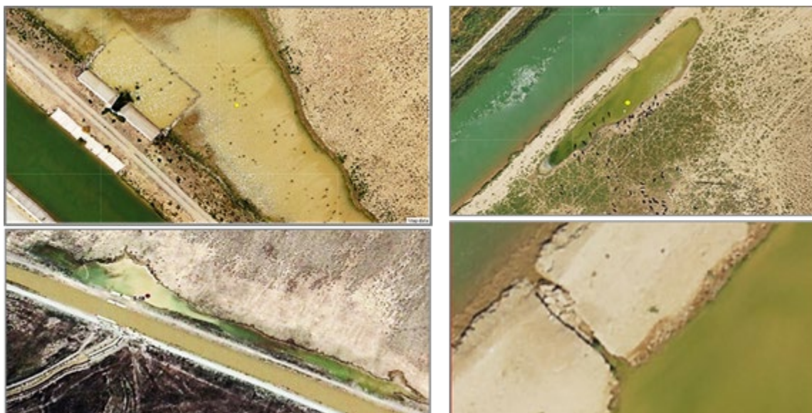
Рис.15. Разливы воды в пунктах водопоя скота при наличии оборудованного водовыпуска (слева, снимок дроном и его изображение на карте “Google Earth”, Т-13), а также при его отсутствии (справа).
