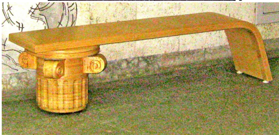
Рис. 5,6. Лава (загальний вид та деталь). Курсова робота за темою «Концептуальні меблі для рекреаційного простору», 2016 р. Матеріал - багат шарова фанера, технологія - гнуття та гравірування на верстаті з ЧПУ. Студ. 5 курсу спец. «Дизайн меблів» Безпалих Діана. Об'єктвиконано групою студентів спеціалізації «Дизайн меблів».
