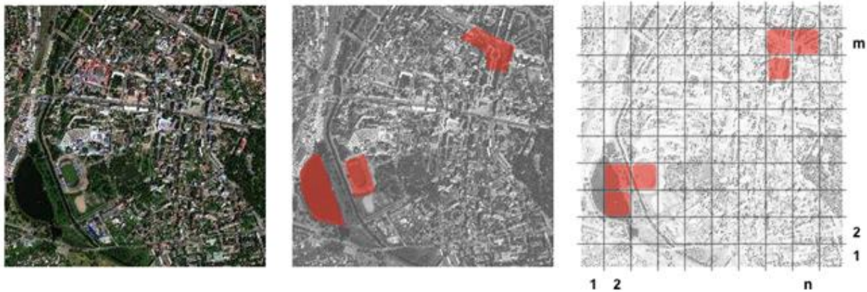
Рис. 1. Покрокова фрагментація карти місцевості польоту БПЛА
