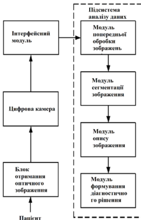
Рисунок 2 – Схема сучасної системи цифрової дерматоскопії
