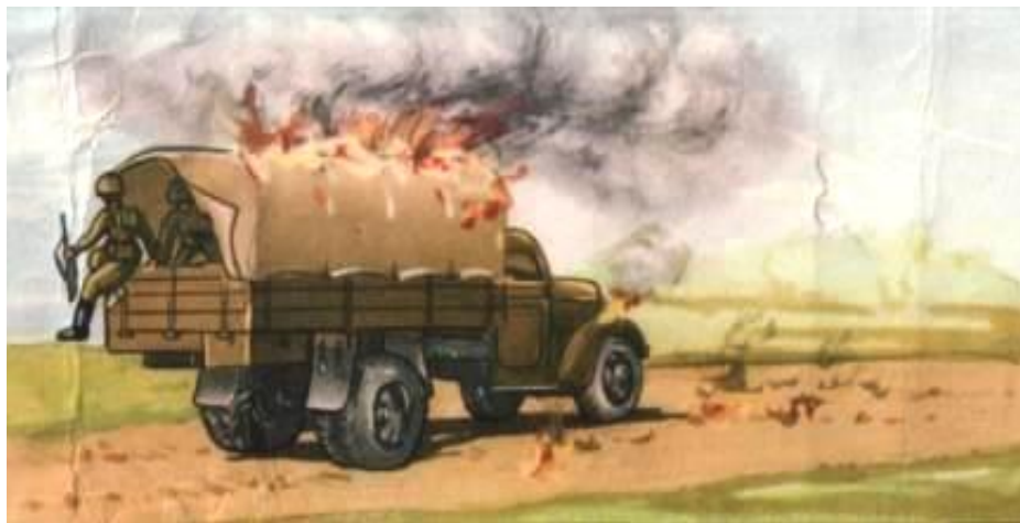
Рис. 26. Автомашини з тентами або накриті брезентом забезпечують короточасний захист від запалювальних речовин
