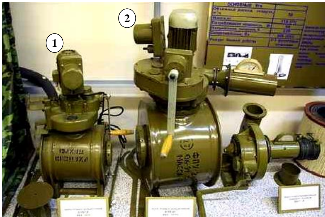
Рис. 15. Фільтровентиляційні агрегати ФВА 1 – ФВА-50/25; 2 – ФВА-100/50.
