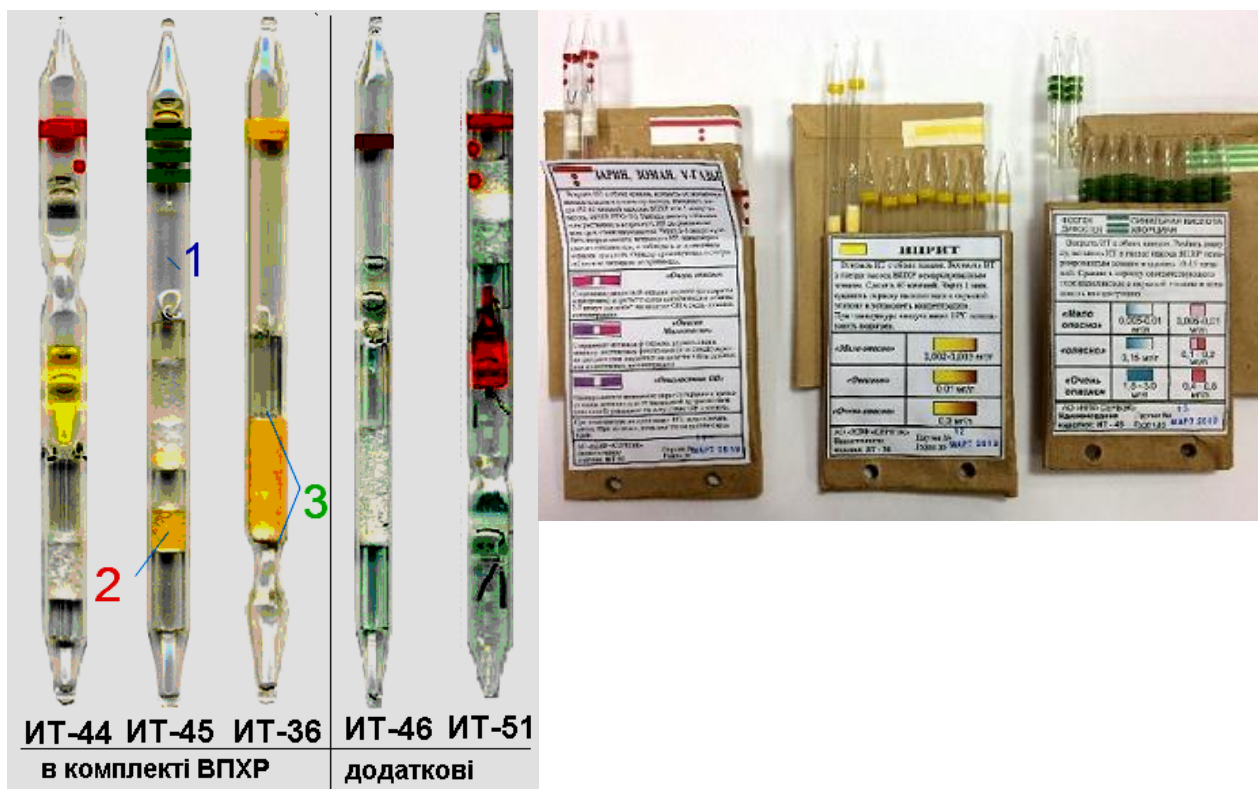
Рис. 35. Загальний вид індикаторних трубок: 1 – скляна ампула; 2 – внутрішні ампули; 3 – наповнювач, який змінює колір під дією ОР.
