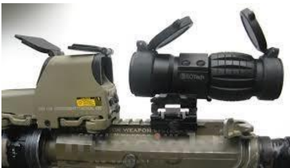
Рис. 43. Поєднання коліматора (ліворуч) та маґніфікатора (праворуч) на одній планці Пікатіні.
