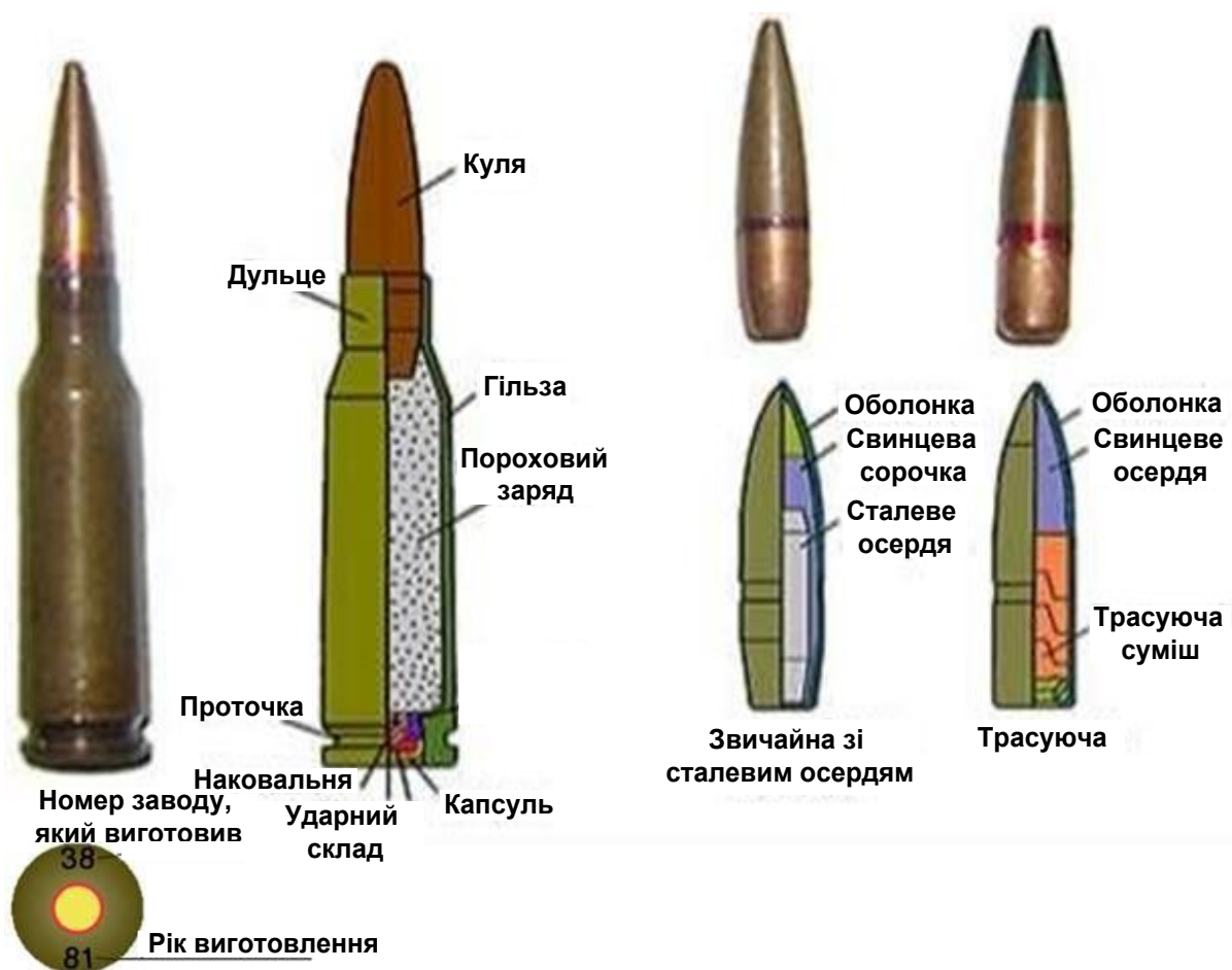
Рис. 74. Будова автоматного патрона 5,45×39 мм та його маркування
