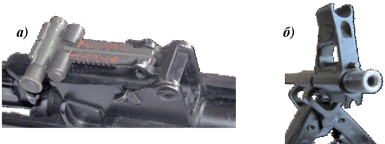
Рис. 32. Прицільний пристрій: а – приціл; б – мушка.
