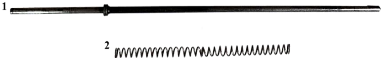
Рис. 73. Штовхач із пружиною: 1 – штовхач; 2 – пружина штовхача.
