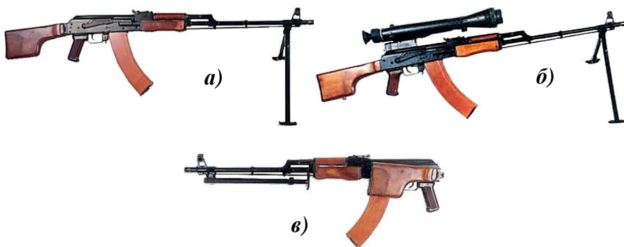
Рис. 27. Загальний вигляд 5,45-мм кулемета Калашникова: a – із постійним прикладом (РПК-74); б – постійним прикладом і нічним прицілом (РПК-74Н); в – прикладом, що складається (РПКС-74).
