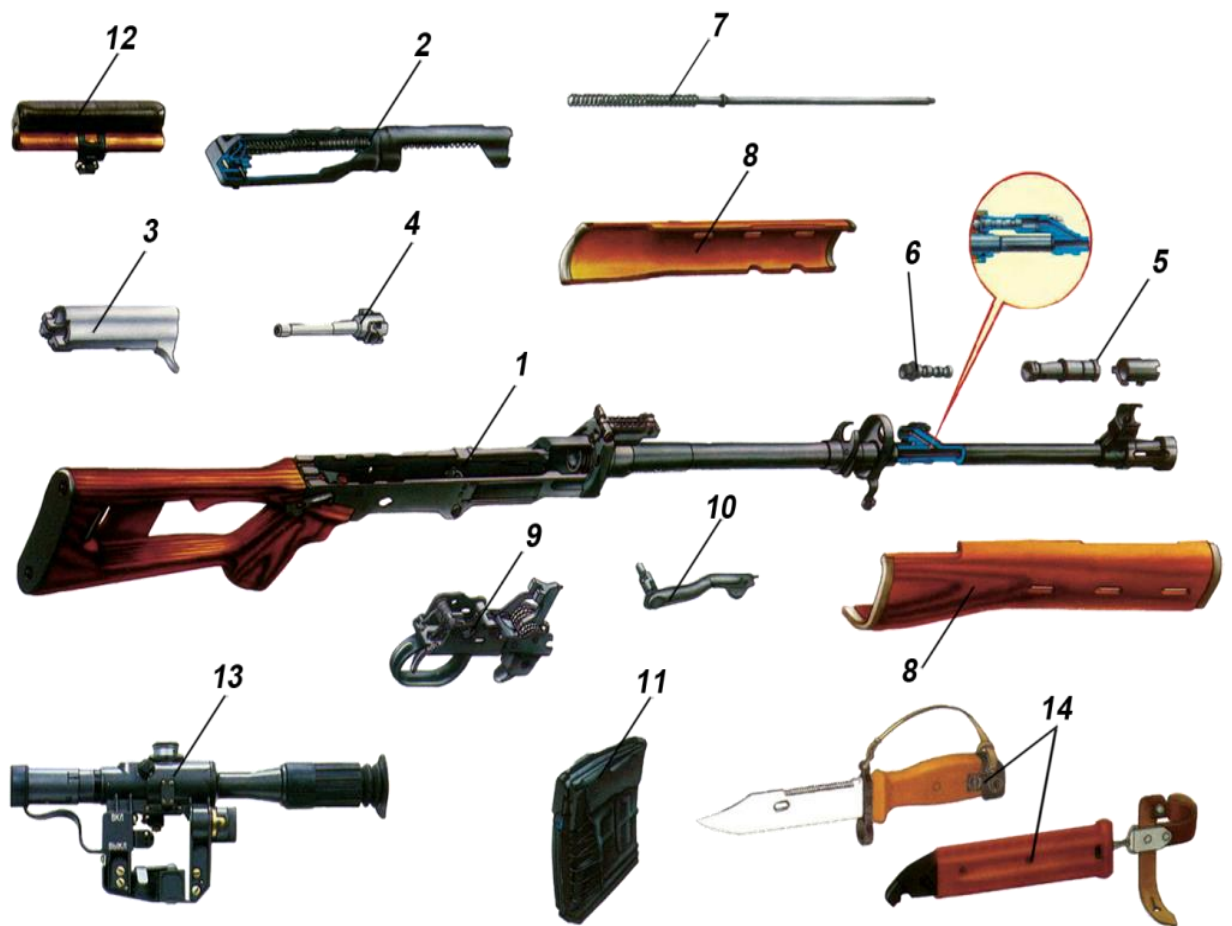
Рис.68. Основні частини й механізми снайперської гвинтівки
