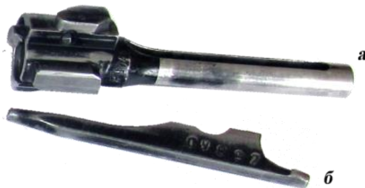
Рис. 55. Затвор з ударником: а – затвор; б - ударник
