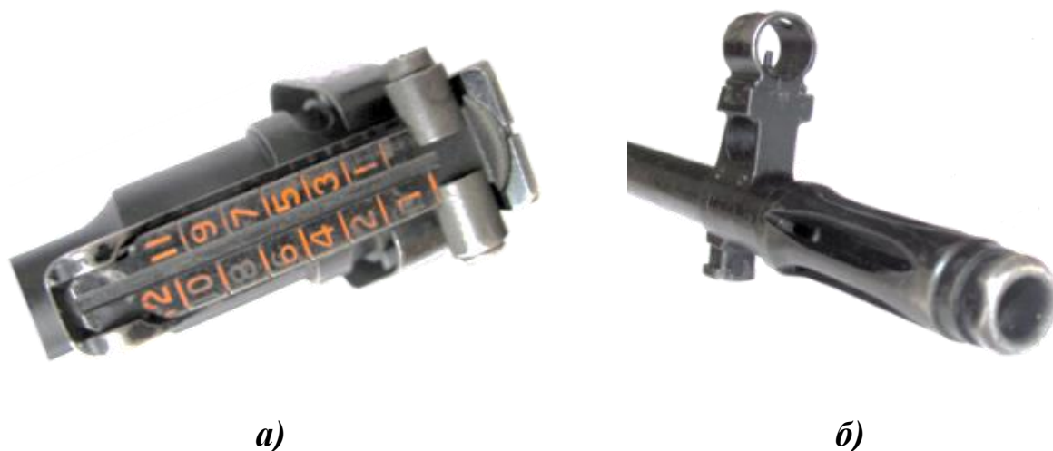
Рис. 82. Механічний (відкритий) приціл: а – приціл; б – мушка
