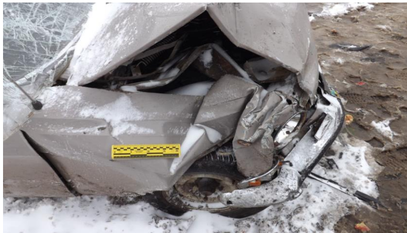
Детальна фотозйомка. Характер ушкоджень передньої частини автомобіля «ГАЗ»
